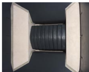
Zgazujący ruszt obrotowy
